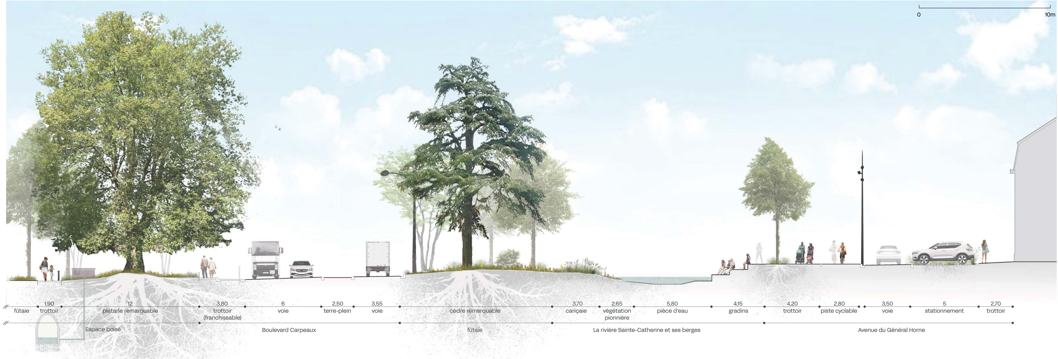
Coupe transversale BB' de la rue de Famars au Boulevard Saly prolongé
